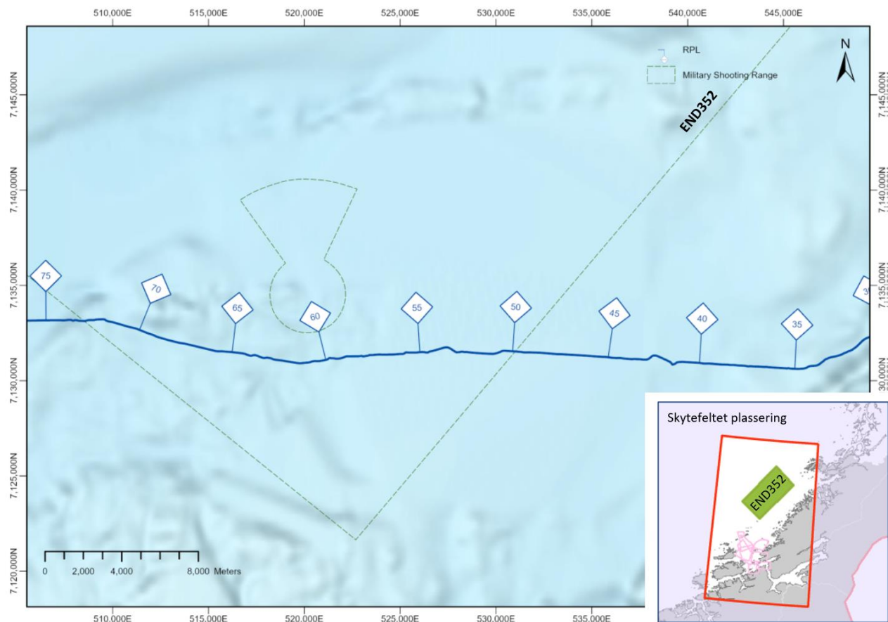
Figur 10: Sjøkabeltraséen krysser sørlige hjørne av Forsvarets skyte- og øvingfelt – END352 Halten.
