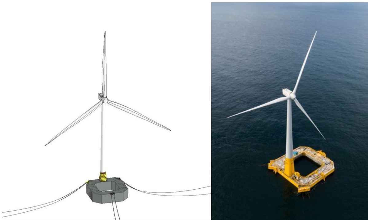
Figur 4. Illustrasjon av valgt konsept for flytende vindturbin på Brage. Kilde: BWI
